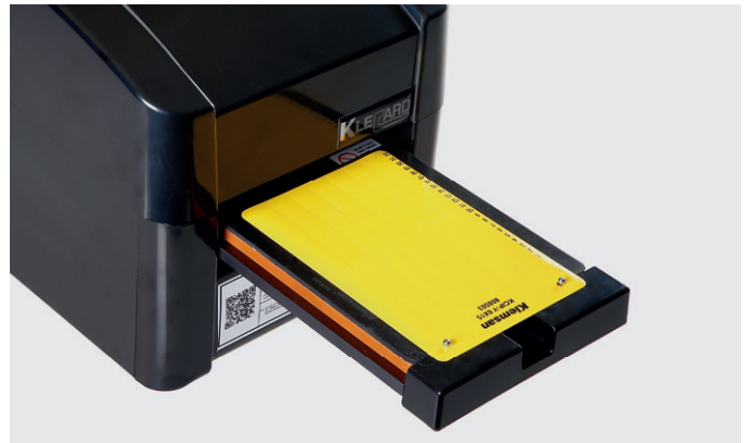
Düz Etiket Plakası ve Etiketinin Montajı
